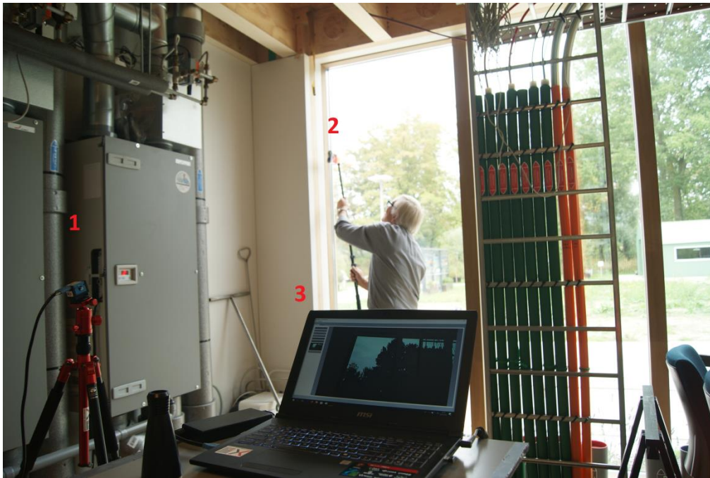
Figuur 10: Opstelling ultragrafie meting: 1. Camera 2. Ontvanger 3. Laptop met software. De ultrasoon geluidsbron staat buiten en is niet zichtbaar op deze foto. Bron: Insiter
