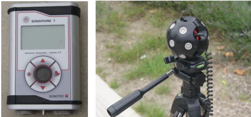
Figuur 4: Ultrasoon generator en geluidsbron Bron: Insiter
