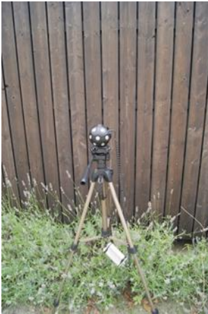
Figuur 12: Opstelling geluidsbron Bron: Insiter
