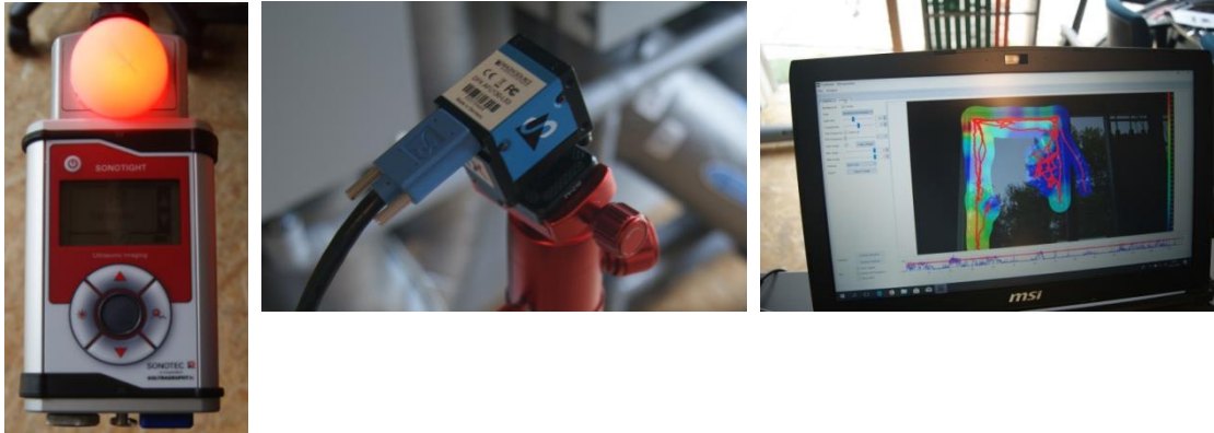
Figuur 6: Ontvanger, camera en laptop met software voor ultragrafie Bron: Insiter
